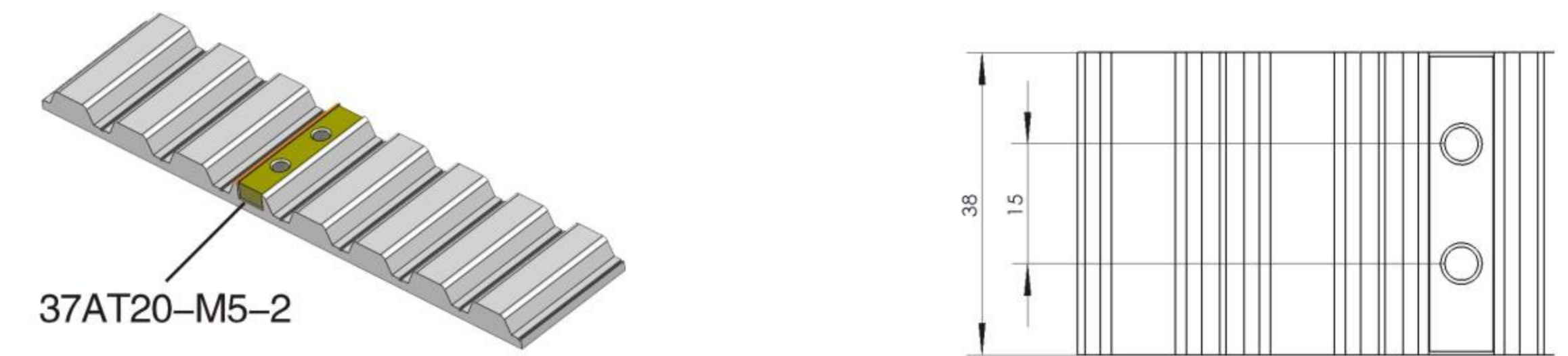
37AT20-M5-2适用AT20齿形, 38mm宽, 双销, 中心距15mm
